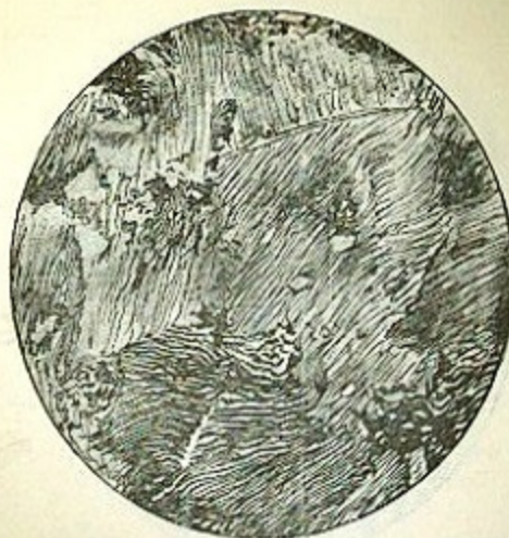
Фиг. 212. Инструментальная сталь эвтектоидного состава. Один перлит (зернистое строение)
