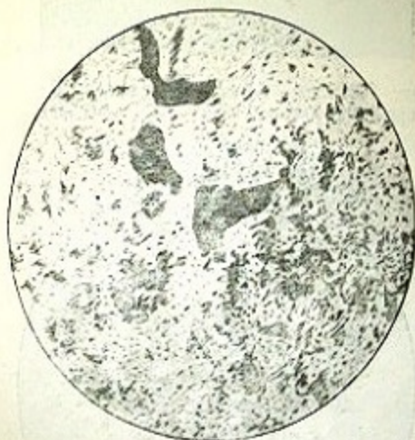
Фиг. 220. Инструментальная сталь, закаленная в масле при 800^{\circ} (без отпуска). Феррит+Сорбит.
