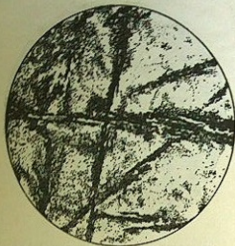
Фиг. 209. То же что на фиг. 207, но после отжига при 1100° Цементит+Перлит.
