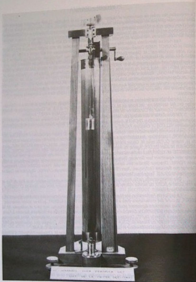
186 - Appareil pour étudier les lois de la chute des corps.
